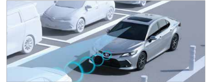
HỆ THỐNG CẢNH BÁO TIỀN VA CHẠM (PCS) Là hệ thống an toàn chủ động, khi phát hiện va chạm có thể xảy ra với phương tiện khác, hệ thống sẽ cảnh báo người lái đồng thời kích hoạt phanh hỗ trợ khi người lái đạp phanh hoặc tự động phanh khi người lái không đạp phanh.
