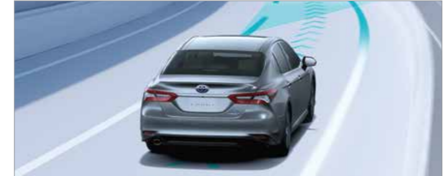
HỆ THỐNG CẢNH BÁO LỆCH LÀN VÀ HỖ TRỢ GIỮ LÀN ĐƯỜNG (LDA & LTA) Hệ thống cảnh báo người lái bằng chuông báo và đèn cảnh báo khi xe bắt đầu rời khỏi làn đường mà không bật tín hiệu rẽ từ người lái. Hệ thống cũng có thể kích hoạt hỗ trợ lái để điều chỉnh bánh lái và ngăn không cho xe rời khỏi làn đường.
